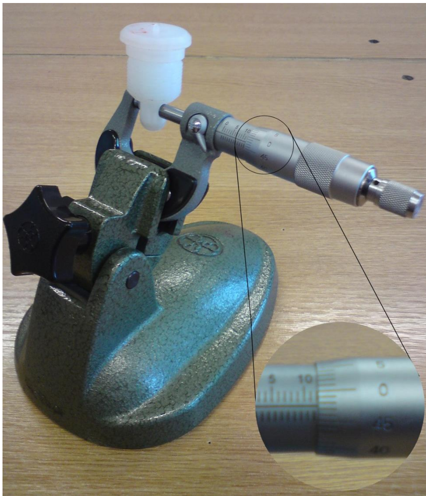
10. ÁBRA: MIKROMÉTER LEOLVASÁSA
